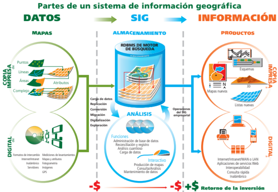
Figura 1. Partes de un sistema de información geográfica (SIG) (Tomlinson, 2007).
